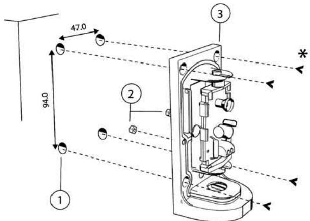
\* Orificio Ø 4 - Foro ø 4 - Hole Ø 4
